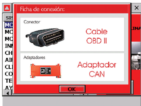
Detalles de conexión
